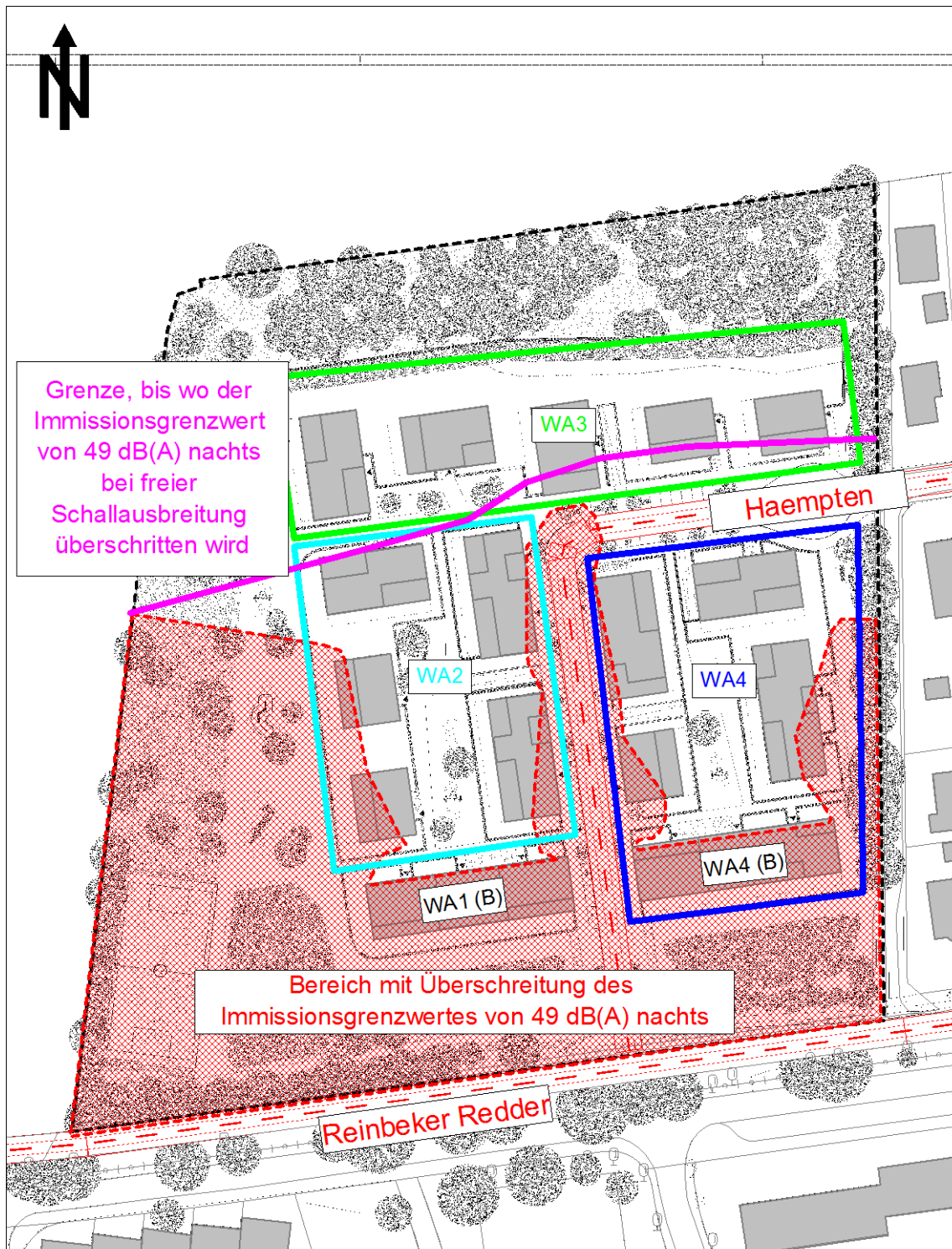
Abbildung 1: Lage der von Überschreitungen des Immissionsgrenzwertes von 49 dB(A) nachts betroffenen Bereiches, Maßstab 1:1.500
